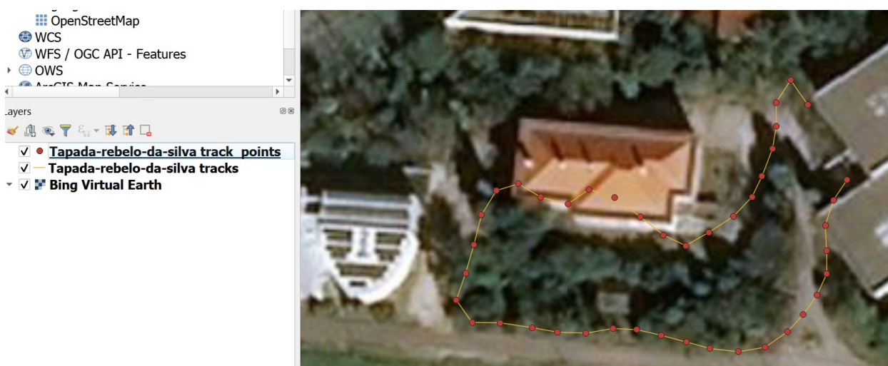
Figura 6: Conjunto de dados geográficos de tipo ponto e linha representando medições GPS junto ao edifício Rebelo da Silva
