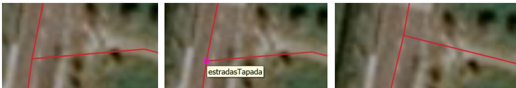
Figura 5: mover um vértice que pertence a várias features com opção “topological editing”
