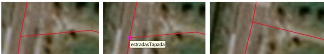
Figura 5: mover um vértice que pertence a várias features com opção “topological editing”
